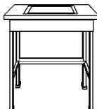
Este o masa cu o baza foarte stabila, care elimina toate vibratiile si miscarile. Partea interioara a mesei, are o placă de marmură pe care se asează cantarul.
