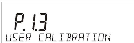
Prima procedura din cardul procesului, consta in introducerea masei greutatii folosite pentru reglare. Masa trebuie sa fie  $\geq 30\%$  din capacitatea maxima.
